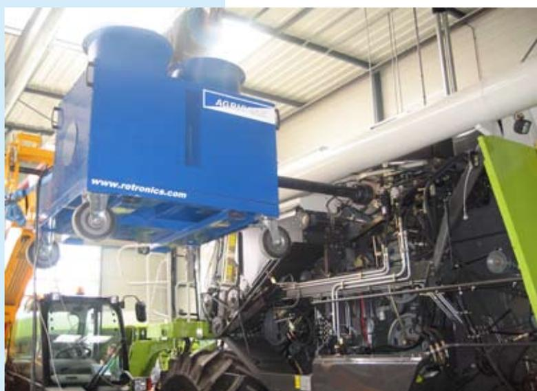
Des guides, placés sous le banc permettent de le mettre à hauteur facilement avec un engin de manutention équipé de fourche afin de réaliser des tests sur les engins automoteurs.
