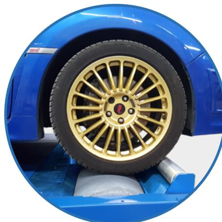
Le banc est équipé de série de rouleaux stabilisateurs. Il s'agit de dispositifs en avant des rouleaux principaux sur lesquels le véhicule vient s'appuyer lors du positionnement d'une voiture.
