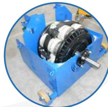
Les avantages de cette technique sont multiples : force de freinage, endurance, durée de vie, absence d'entretien. Autant d'éléments que ne proposent pas les autres technologies comme les freins hydrauliques ou pneumatiques par exemple.
