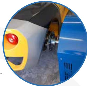
Pilotée par une électronique de gestion rapide haute performance, la charge appliquée à chaque roue est calculée 100 fois par seconde. Nous sommes ainsi capables de percevoir la moindre modification de comportement du véhicule. Cette vitesse de calcul, couplée à une inertie particulièrement faible nous permet un temps de réaction du système particulièrement court et HubScan est ainsi capable d'observer tous les phénomènes moteurs.
