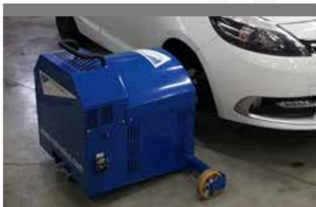
Un sol plat suffit à son utilisation, permettant de déplacer les pods au gré de vos envies dans votre local. Chaque châssis est monté sur roulettes haute résistance, permettant de le déplacer avec un effort moindre, tout en supportant le poids du véhicule. Pour faciliter la tâche, une poignée ergonomique sur chaque pod permet tout simplement de les positionner face au véhicule testé.
