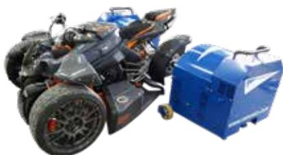
De part son fonctionnement, HubScan permet une très large palette d'utilisation. En effet, par son inertie quasi nulle, le dispositif peut être mis en place pour des voitures très légères type mini véhicule électrique, comme sur des véhicules beaucoup plus puissants tels que des véhicules de rally-raid ou même de dragster, pour lesquels l'utilisation d'un banc à roulement est délicate. Il reste évidemment utilisable pour des véhicules plus conventionnels du parc automobile.
